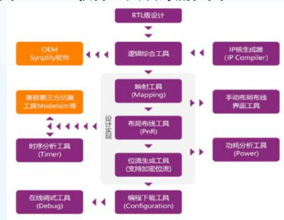
图：FPGA软件工具设计流程图
