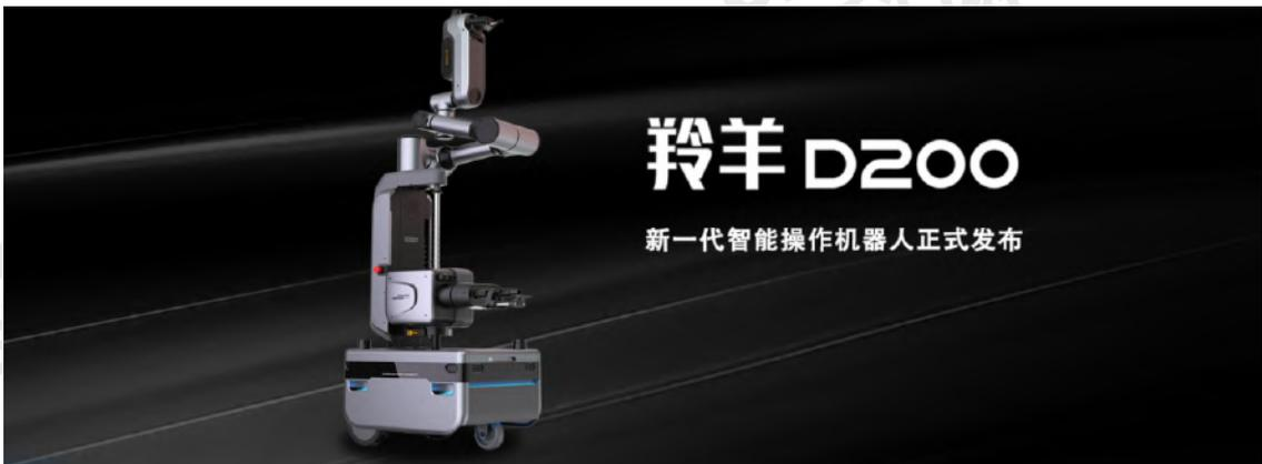
亿嘉和公司旗下的羚羊D200产品搭载高精度操作平台(绝对精度<1mm),同时可实现多自由度高扭矩(最高输出可达206N.m)。该款产品是面向多行业多场景应用(电力、轨交、数据中心等)的智能操作机器人,具备全自动作业能力,用以执行标准化操作、应急操作及巡检任务,可以满足无人运维及巡检需求。
