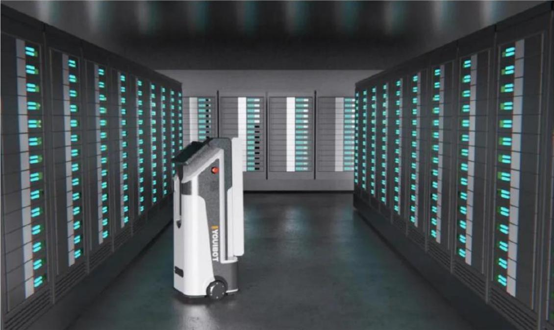
针对IDC巡检所面临的人力缺口、漏检风险、能耗大等痛点,优艾智合移动智能巡检机器人在机房内自主巡检、智能分析、故障快速定位,提升巡检效率及准确率,保障机房稳定高效地运行,同时辅助数据机房优化资源降低能耗,实现绿色转型升级。
