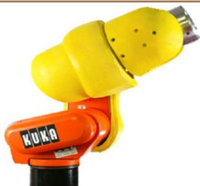
图 47：早期协作机器人直接在外包裹软垫
