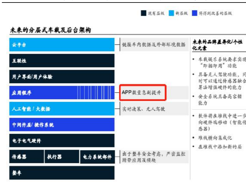
图表 23 由软件推动的以个性化服务为导向的汽车新架构
