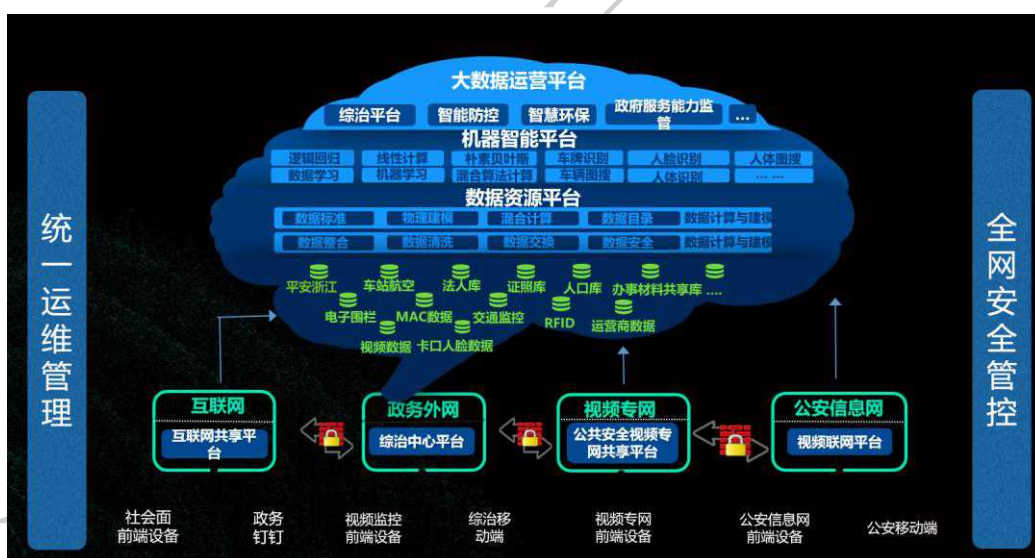
图 6 “衢州雪亮工程”架构
